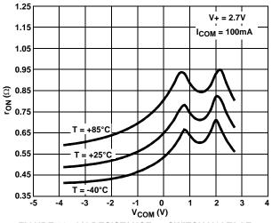
FIGURE 11. ON-RESISTANCE vs SWITCH VOLTAGE
