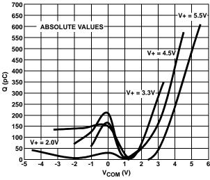
FIGURE 14. CHARGE INJECTION vs SWITCH VOLTAGE
