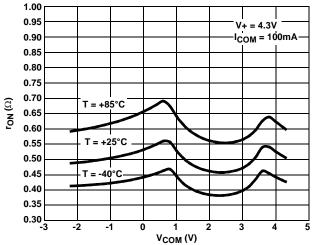
FIGURE 10. ON-RESISTANCE vs SWITCH VOLTAGE
