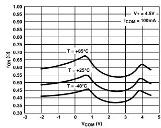
FIGURE 9. ON-RESISTANCE vs SWITCH VOLTAGE
