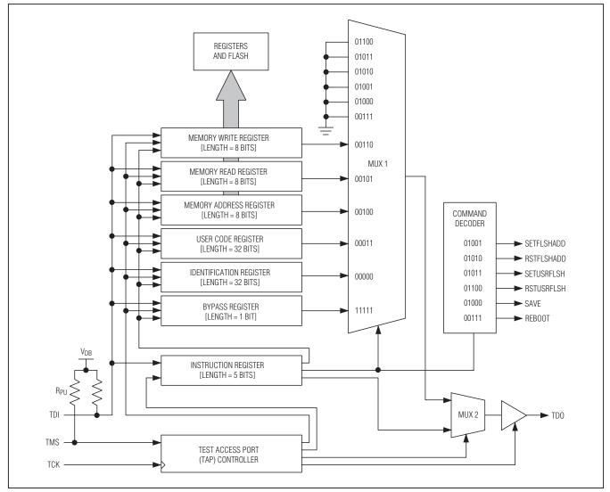
Figure 12. JTAG Block Diagram
