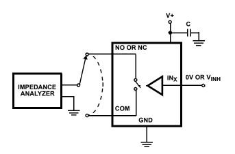
FIGURE 7. CAPACITANCE TEST CIRCUIT
