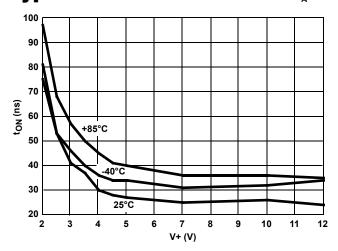
FIGURE 13. TURN-ON TIME vs SUPPLY VOLTAGE
