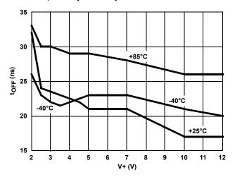
FIGURE 14. TURN-OFF TIME vs SUPPLY VOLTAGE
