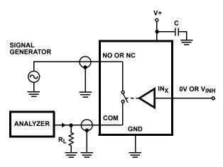
FIGURE 4. OFF-ISOLATION TEST CIRCUIT
