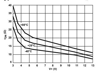
FIGURE 9. ON-RESISTANCE vs SUPPLY VOLTAGE
