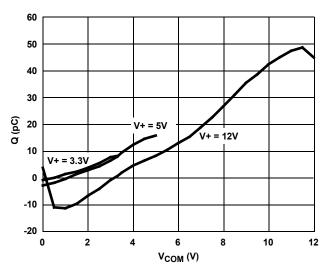
FIGURE 12. CHARGE INJECTION vs SWITCH VOLTAGE
