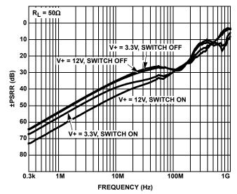
FIGURE 18. ±PSRR vs FREQUENCY
