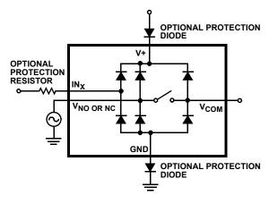
FIGURE 8. OVERVOLTAGE PROTECTION
