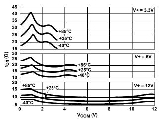
FIGURE 10. ON-RESISTANCE vs SWITCH VOLTAGE
