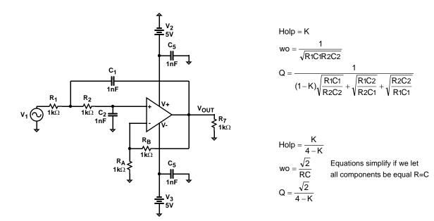
FIGURE 29. SALLEN KEY HIGH PASS FILTER
