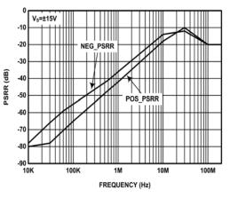
FIGURE 18. POWER SUPPLY REJECTION RATIO (PSRR)
