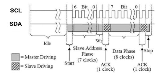
Figure 9 Send Byte Example
