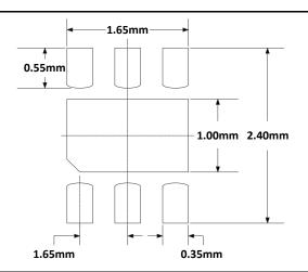
Figure 14 · LU 6-Pin UDFN Package Footprint
