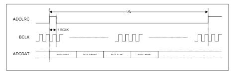
Figure 46 TDM in DSP Mode B
