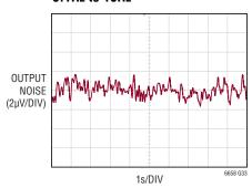
2.5V V<sub>OUT2</sub> Output Noise 0.1Hz to 10Hz
